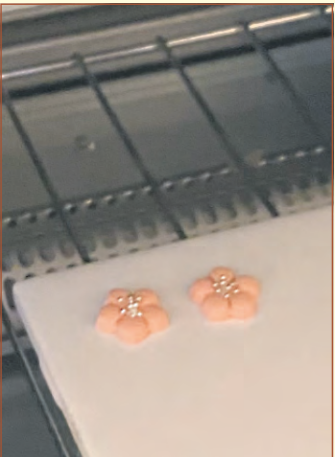
Die entstandene Blütenform wird mithilfe eines Metallmessers vorsichtig vom Untergrund gelöst. Die ausgestanzten Blütenformen werden nun auf eine handelsübliche Fliese gelegt. Danach können Schmuckelemente in der Mitte der Blüte platziert werden. Nach diesem Arbeitsschritt werden die Schmuckstücke gebrannt.
