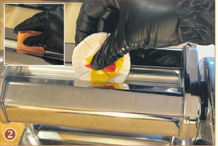
Die zusammengestellten Farbanteile werden mit der elektrischen Nudelmaschine so lange verwalzt, bis der gewünschte Farbton erreicht ist. Auf dem eingeklingelten Foto sind alle Farbanteile gut vermischt. Anschließend wird die Dicke des Schmuckornaments festgelegt.
